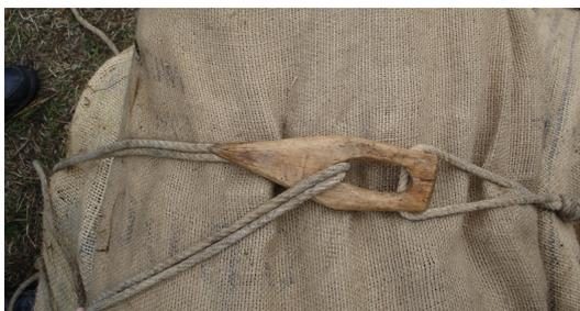
Une forte traction sur la corde passée dans le grand orifice permettait de serrer fortement la charge...
