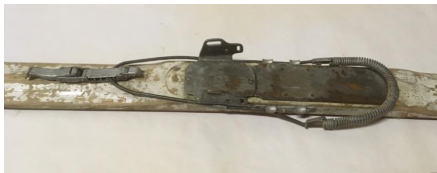
Photo 2 Fixation Kandahar. Les lanières de l'étrier manquent.
